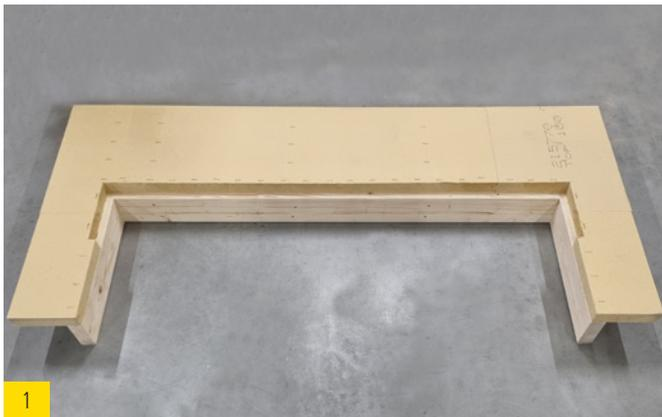
1 Laisser la zone libre sur la moitié du montant / de la traverse mais au minimum 40 mm au niveau du LAMBREQUIN. En conséquence choisir un montant et une traverse d'une largeur d'au moins 80 mm.
