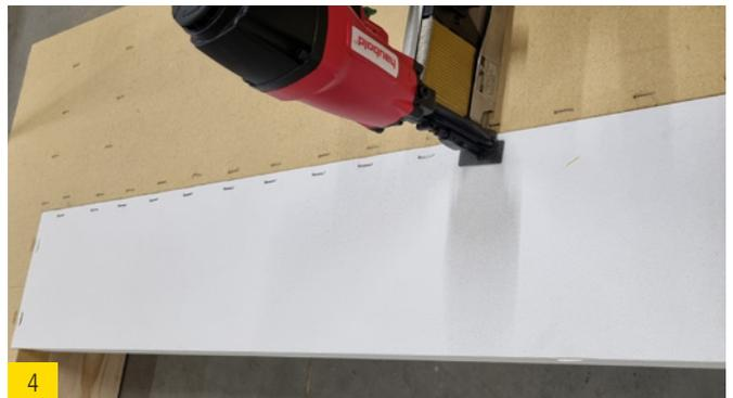
4 Assembler avec des agrafes à dos large avec un entreaxe de 10 cm (distances entre les bords dans le sens de la longueur du joint  $\leq 70$  mm & distances entre les bords dans le sens de la largeur du joint min. 20 mm!)
