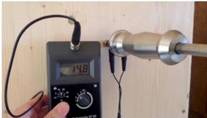
Humidité d'une construction d'ossature bois  $\leq 18\%$ .
