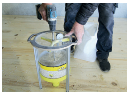
Effectuer le remplissage de la CLT BOX – DECKE FS à l'aide d'une visseuse sans fil
