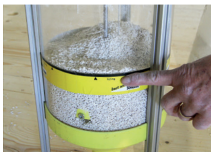
Pour livraison des granulés de remplissage en BigPack, remplir jusqu'au trait de repère = 12,5 kg
