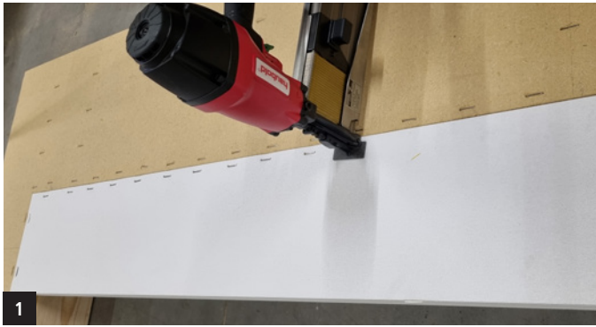
1 Agraffer tout le contour du LAMBREQUIN à la moitié de la largeur du montant/de la traverse.
