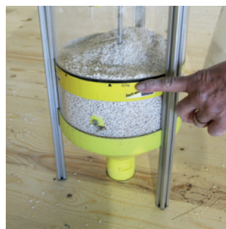
Lors de livraison des granulés de remplissage en Big Bag, remplir jusqu'au trait de repère = 12,5 kg
