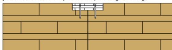
Figure 2 : Jonction des panneaux best wood CLT entre eux – Plancher (coupe verticale)
