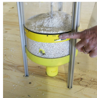
Bei Lieferung der Schüttung in BigPack wird die Schüttung bis zur Markierung eingefüllt = 12,5 kg
