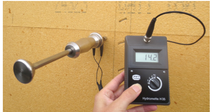
Plattenfeuchte \leq 19,5 % mit Einstellung Fichte/Kiefer.
