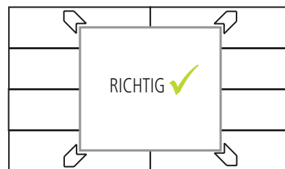
Keine Plattenstöße an Öffnungsecken!
