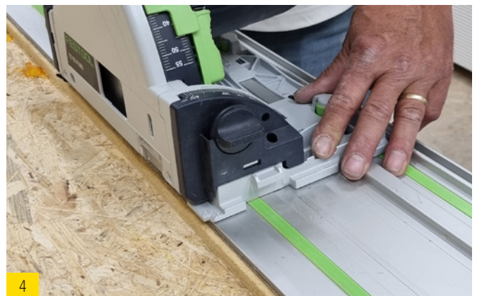
4 Den Dichtkeil und die beiden Dichtecken an der vorderen Kante auf die gewünschte Tiefe absägen.
