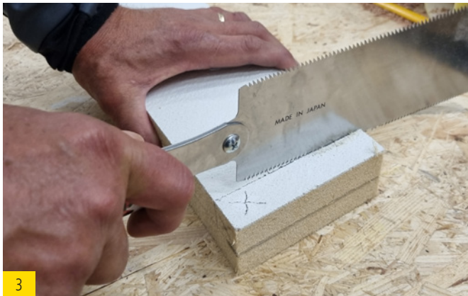
3 Mit einer Handsäge markiertes aussägen.
