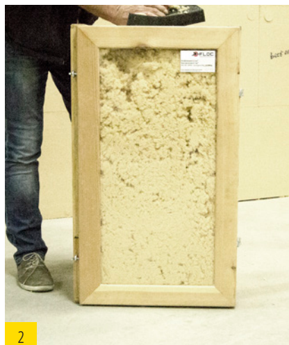
2 Verdichtetes Einblasen mit Schlauch
