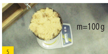
5 Befülltes Prüfrohr erneut wiegen
