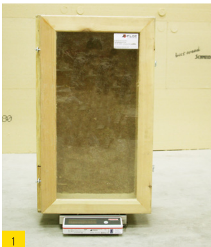
1 Leeres Prüfelement wiegen
