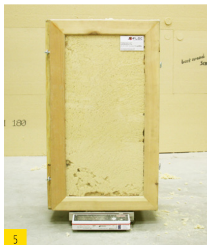
5 Befülltes Prüfelement erneut wiegen
