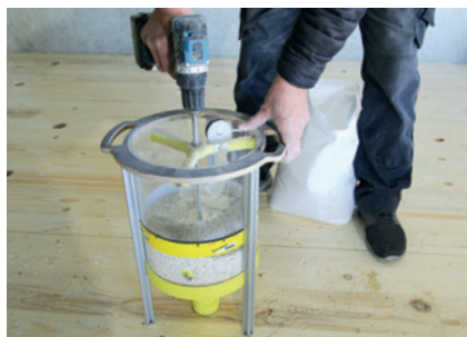
Mit Hilfe eines Akkuschaubers die Schüttung in die CLT BOX – DECKE FS einbringen
