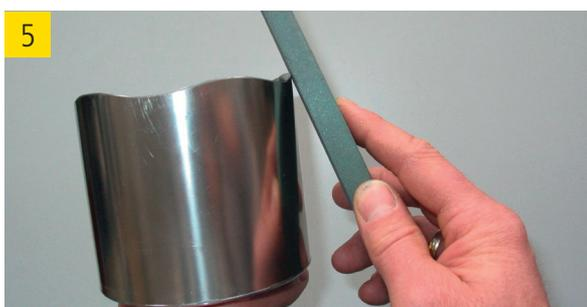
5 Wetzstein mit Öl oder Wasser benetzen und in einem Winkel von 25° ansetzen
