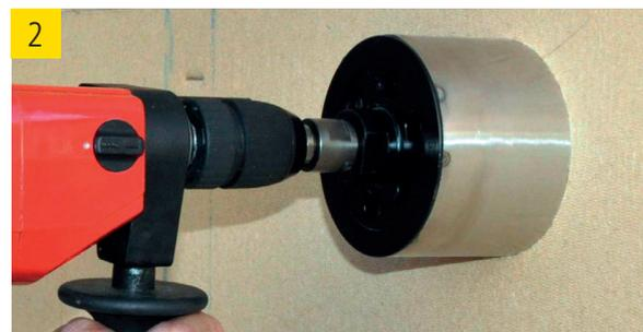
best wood Lochsäge ansetzen, Maschine einschalten und mit mäßigem Druck bohren. Vor Austritt der best wood Lochsäge den Druck reduzieren.
