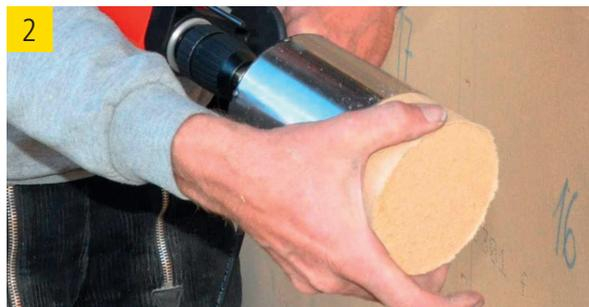
2 Bohrkern entnehmen
