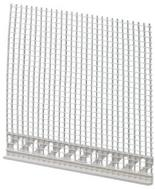
Kunststoffprofil mit Abzugskante, Langlochstanzung und Gewebe ultraschallverschweißt.
