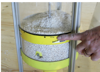
Bei Lieferung der Schüttung in BigPack wird die Schüttung bis zur Markierung eingefüllt = 12,5 kg
