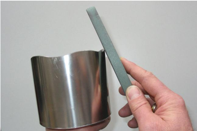
Wetzstein mit Öl oder Wasser benetzen und in einem Winkel von 25° ansetzen.
