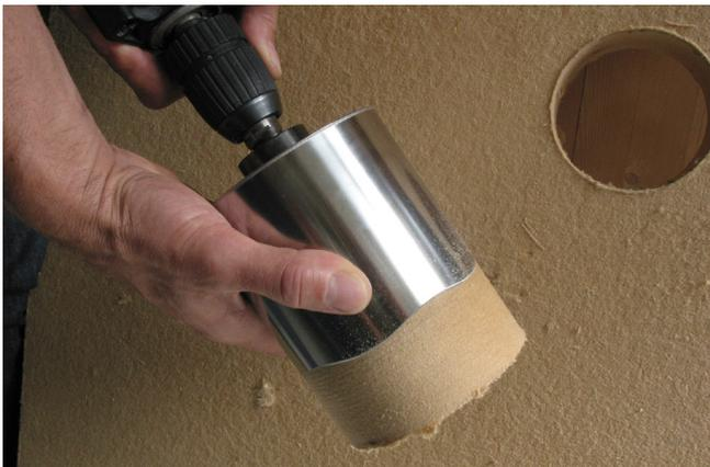
Auswerfer entriegeln und den Bohrkern gleichmäßig bis zum Anschlag nach vorne drücken. Kein zusätzliches Hilfswerkzeug erforderlich.
