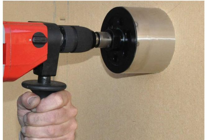
best wood Lochsäge ansetzen, Maschine einschalten und mit mäßigem Druck bohren. Vor Austritt der best wood Lochsäge den Druck reduzieren.
